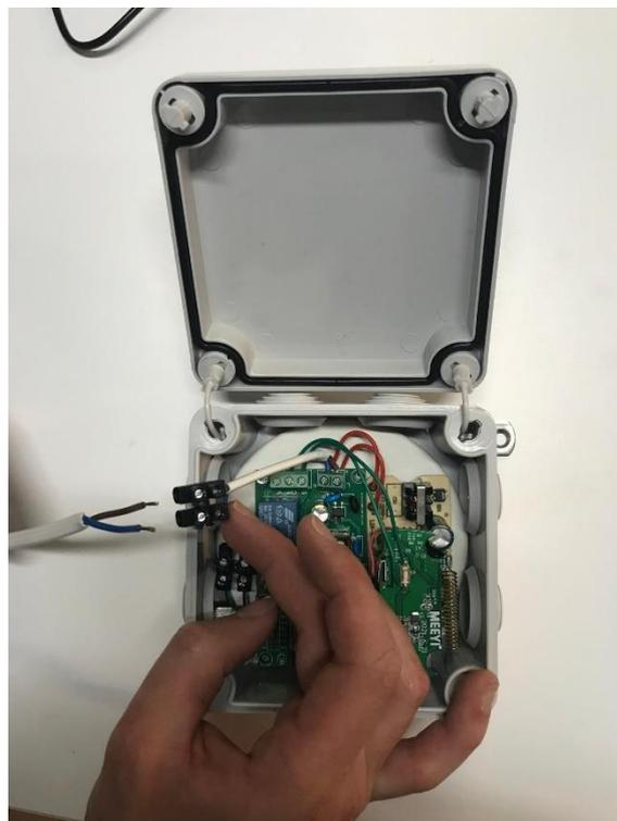
3. Conecte el cableado del sensor de puerta al dispositivo siguiendo las instrucciones proporcionadas en la imagen adjunta.
