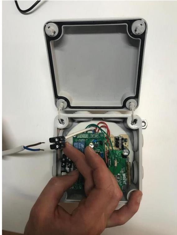
3. Ajuste el radio de alcance del dispositivo. Para ello, tome la pulsera OXN-50 y comience girando la rueda al máximo. Luego, ajuste gradualmente la rueda hasta que el radio de alcance sea adecuado para su situación específica.
