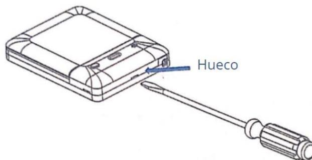
2. A continuación, utilice el destornillador de punta plana para hacer palanca en otras partes de la carcasa superior desde el borde de la brecha.
