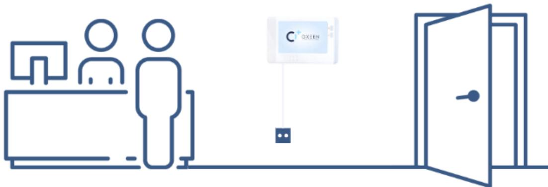
\* El dispositivo debe ubicarse a una altura de 1,5 metros sobre el suelo. Busca una zona cercana a un enchufe para conectar el dispositivo. Además, se recomienda conectarlo directamente a alguna toma del falso techo si es posible.
